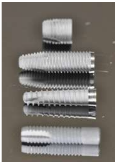
Fig. 1 I quattro tipi di impianti testati
