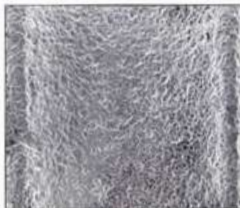
Fig. 2 Fotografia al SEM di impianto SLA 50x.
