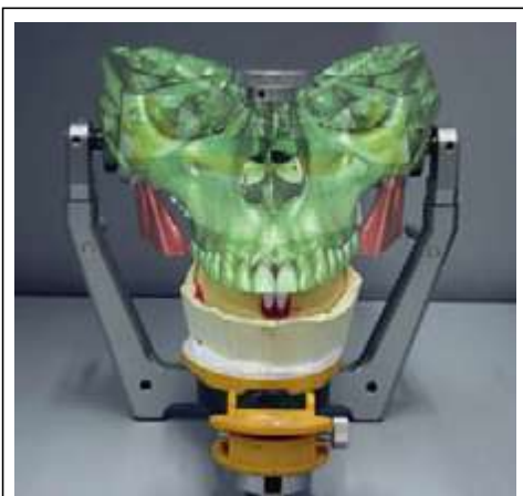
Fig. 2 L'articolatore e il modello virtuale 3D: una volta definite le coordinate spaziali comuni le soluzioni proposte con un metodo diagnostico possono essere trasferite agli altri strumenti di indagine (A. Busato)
